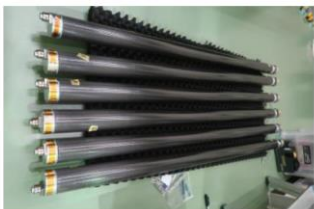
スマートストラット (変位測定 + 変位補正内蔵) CFRPパイプ + アルミフィッティング
